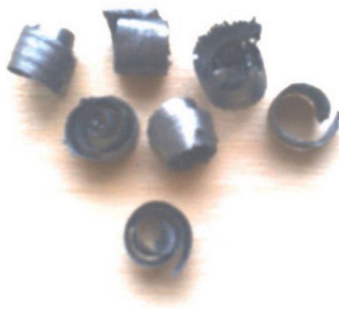
Рис. 6. Элементная стружка после ротационной обработки винтовой поверхности
