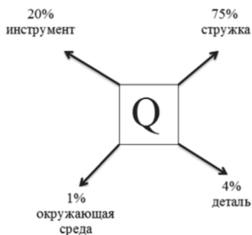
Рис. 9. Распределение тепловых потоков в процентном соотношении
