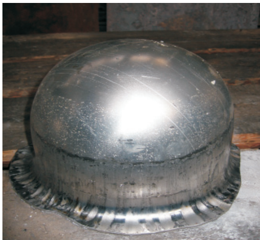
Рис. 1. Фотография вытянутой заготовки титанового сплава BT 14. л.4,0
