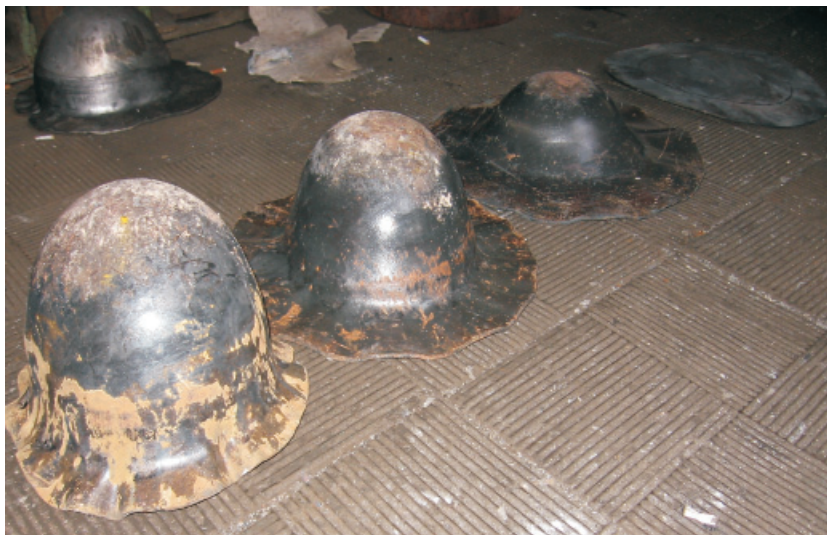
Рис. 5. Фотография изменения формы листовой заготовки толщиной 4,0 мм из титанового сплава ВТ 14, вытягиваемой из-под прижима в условиях горячей деформации
