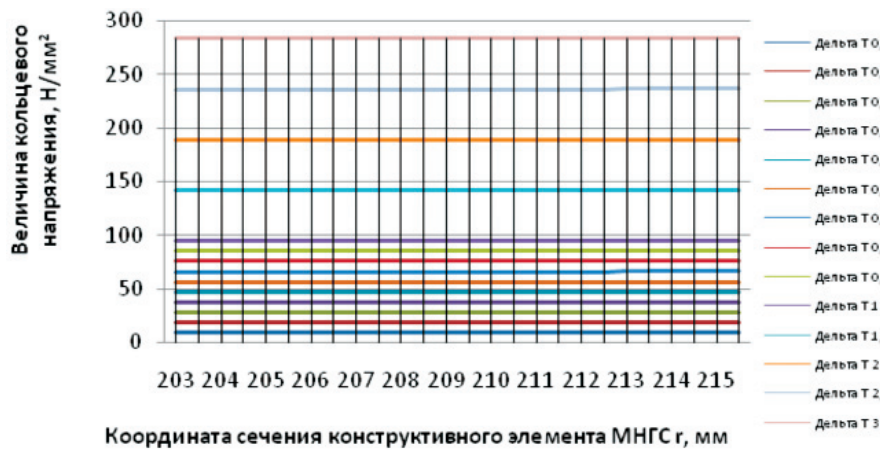
Рис. 3. Распределение кольцевых напряжений по сечению конструктивного элемента МНГС диаметром 430мм и толщиной стенки 12мм при воздействии условно стационарного осесимметричного температурного поля
