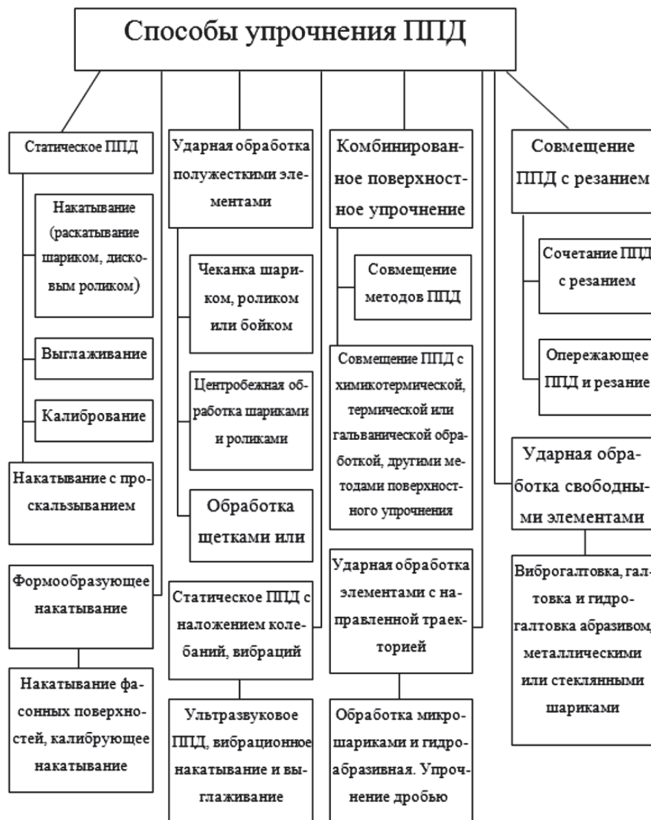
Рис. 2. Классификация способов поверхностного пластического деформирования
