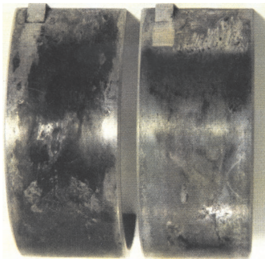
Рис. 2. Фрикционная коррозия на спинке вкладыша
