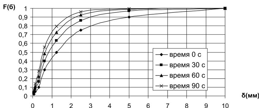
Рис. 3. Сопоставление расчетных и экспериментальных данных по гранулометрическому составу измельченного материала:  $H = 45 \text{ кка/м}; \delta = 2; \alpha = 0,013; k = 1,53$
