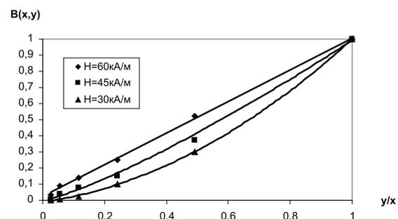
Рис. 2. График распределительной функции  $B(y, x)$  измельчения старого асфальтобетона в электромагнитном поле
