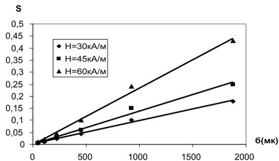
Рис. 1. График селективной функции измельчения старого асфальтобетона в электромагнитном поле
