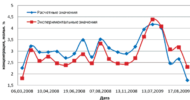
Рис. 5. Сравнение экспериментальных и расчетных концентраций оксидов углерода на выходе из реактора синтеза
