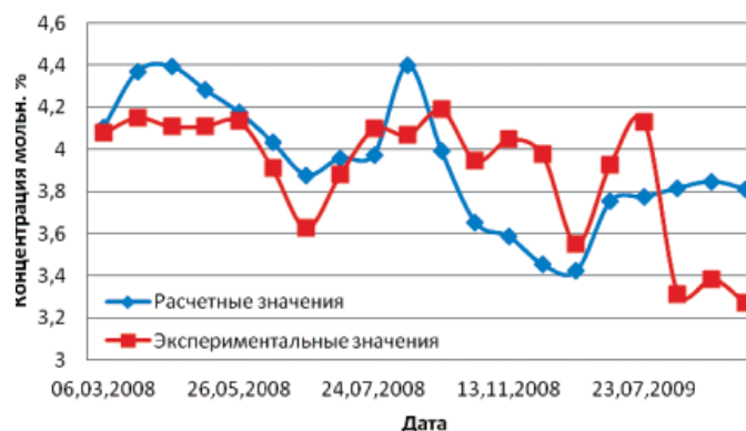
Рис. 3. Сравнение экспериментальных и расчетных концентраций метанола на выходе из реактора синтеза
