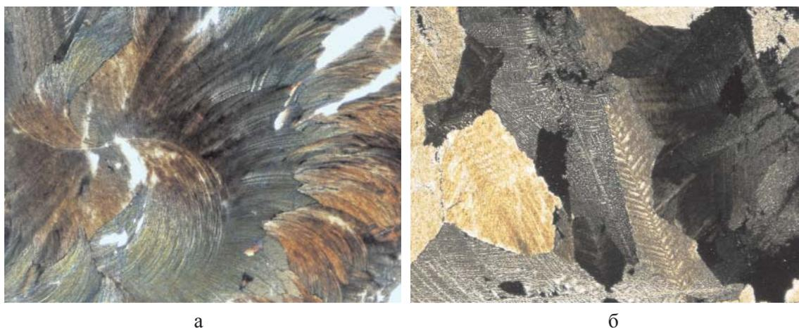
*Рис. 2. Структура термостойкого симинала, полученного в песчно-глинистой форме при скрещенных николях: а – ув.  $\times 50$ ; б – ув.  $\times 100$*
