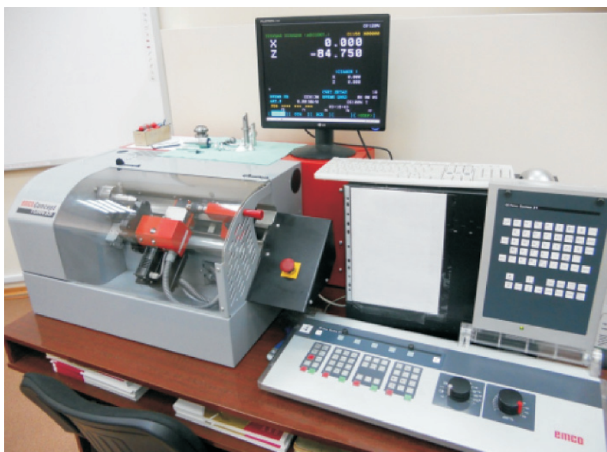
Рис. 2. Отладка управляющей программы и обработка детали на токарном станке с ЧПУ
