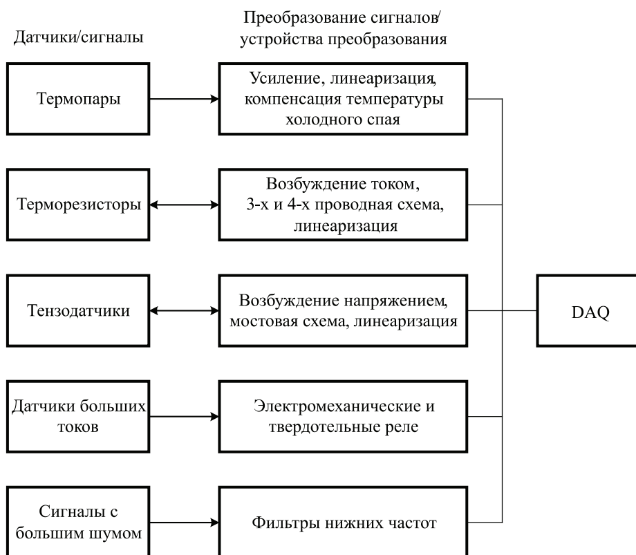
Рис. 5. Типы датчиков и сигналов и виды преобразования
