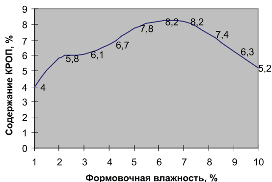
Рис. 1. Зависимость формовочной влажности керамической массы от содержания воды и КРОП. Цифры на графике – значения прочности в кг/см²
