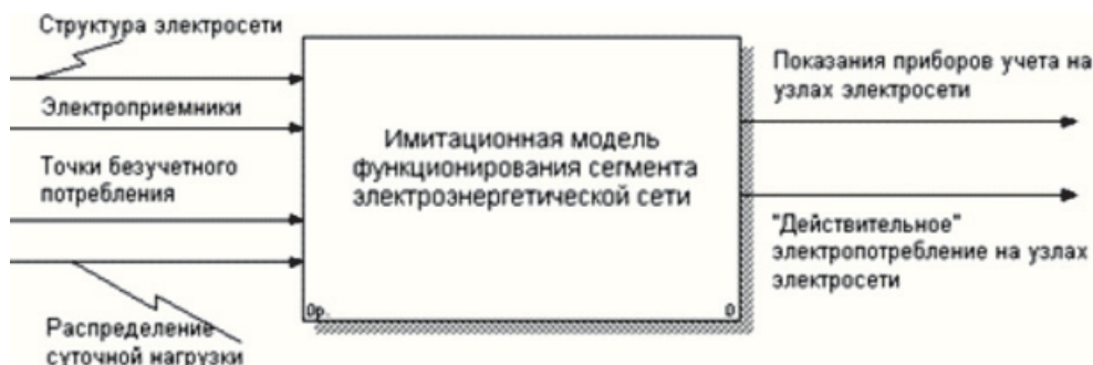
Рис. 1. Схема сегмента модели электросети
