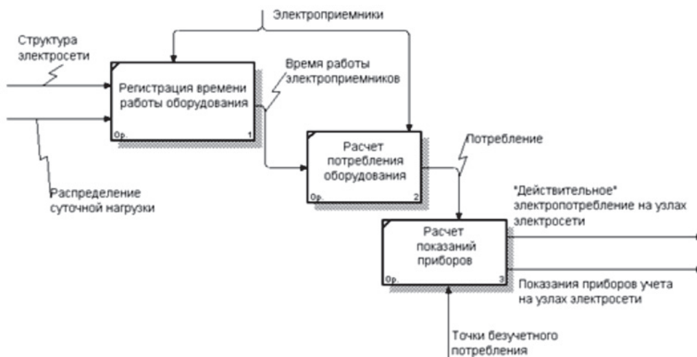
Рис. 2. Развернутая схема функционирования модели электросети
