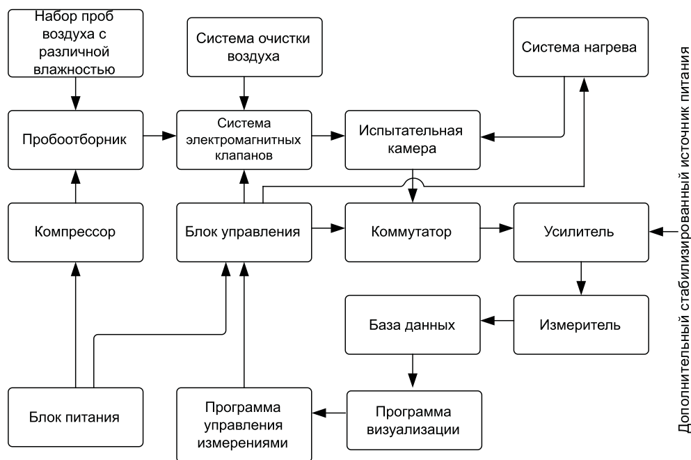
Рис. 1. Структурная схема устройства для исследования полупроводниковых материалов для создания мемристоров
