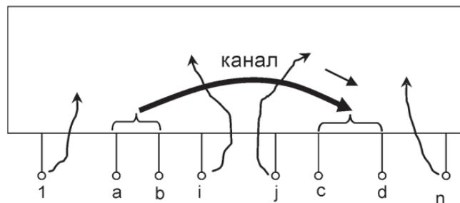
Рис. 2. Выделение каналов передачи информации многополюсника:  $ab$  – вход канала;  $cd$  – выход канала
