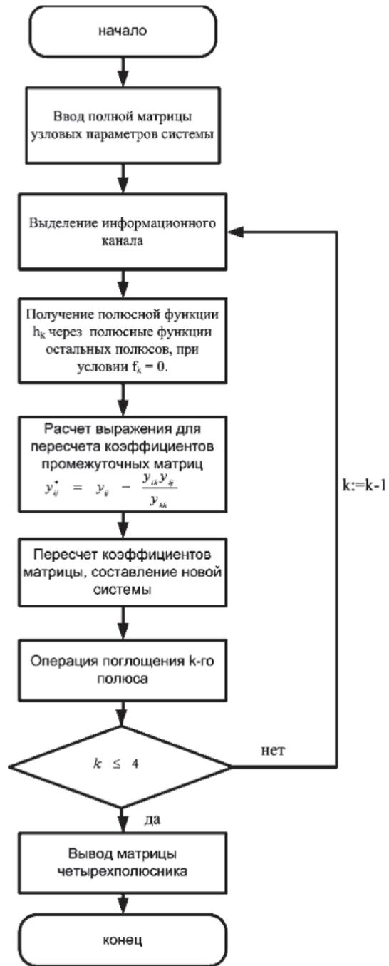
Рис. 6. Блок-схема алгоритма преобразования полной полюсной матрицы многополюсника к эквивалентной матрице четырехполосника
