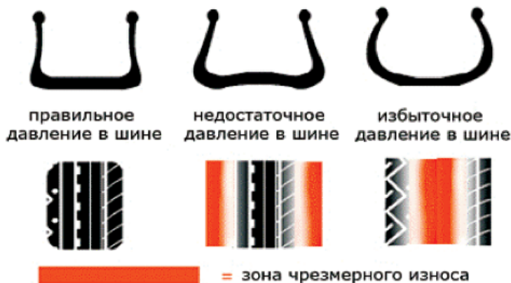
Изнашиваемость шин при различном давлении
