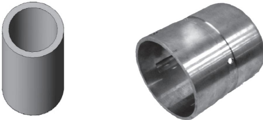
Рис. 1. Втулки после редуцирования
