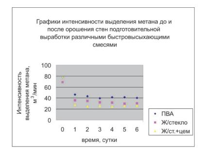
Зависимость интенсивности выделения метана до и после орошения стен подготовительной выработки различными быстровысыхающими смесями от времени
