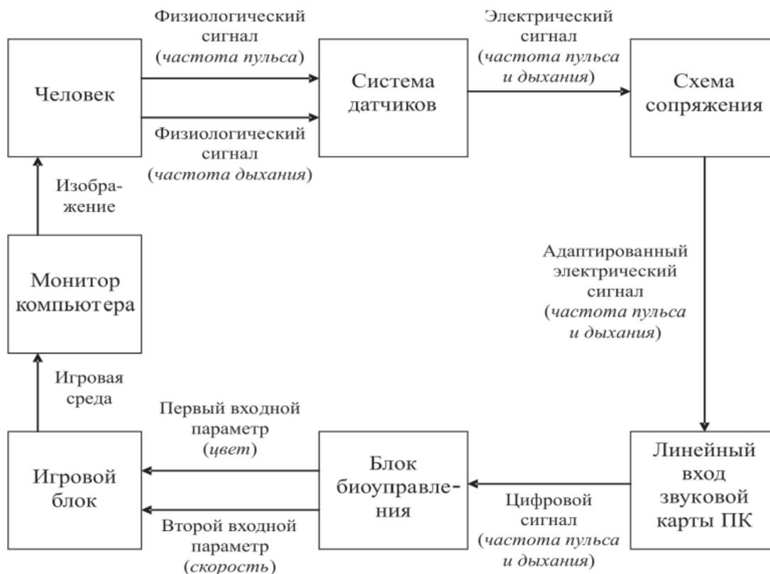
Рис. 2. Модель мультипараметрического канала обратной связи
