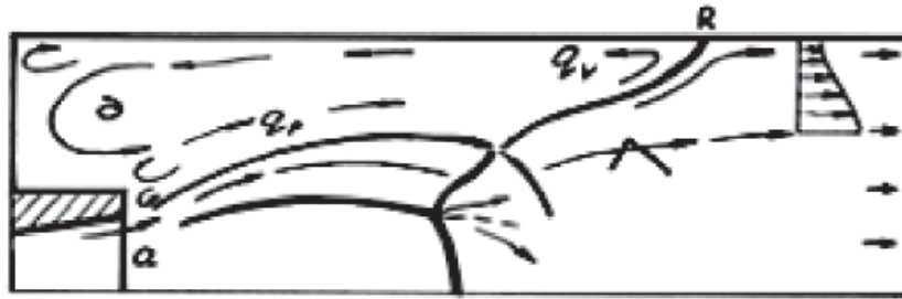
Рис. 4. Внутреннее отрывное течение в канале. Донная область закрыта
