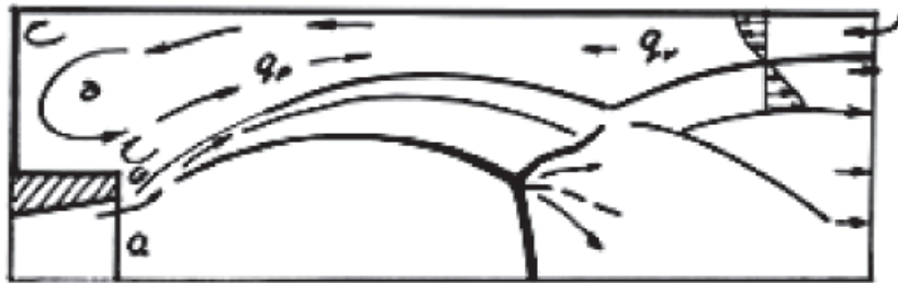
Рис. 5. Внутреннее отрывное течение в канале. Донная область открыта
