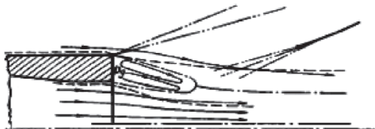
Рис. 3. Внешнее отрывное течение и торроидальная донная область при наличии вдува
