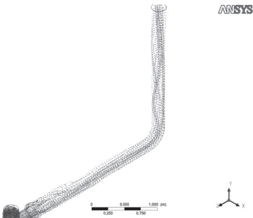
Рис. 6. Векторная диаграмма поля скоростей в трубопроводе после клапана модернизированного (вариант 3)
