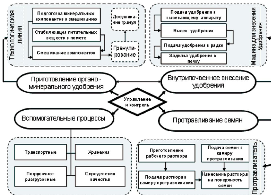
Рис. 5. Структурная модель системы механизированных процессов превентивного ухода за сельскохозяйственными культурами
