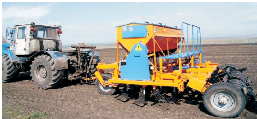
Рис. 3. Сеялка-культиватор ССВ-3,5 с рычажным вариатором в работе
