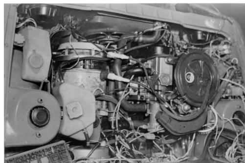
Рис. 4. Размещение КЭСУ в подкапотном пространстве автомобиля
