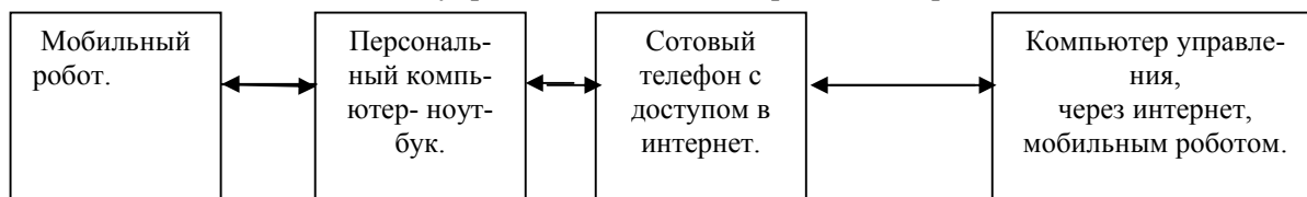
Блок-схема №3, управление мобильным роботом “Ирис – 1”.
