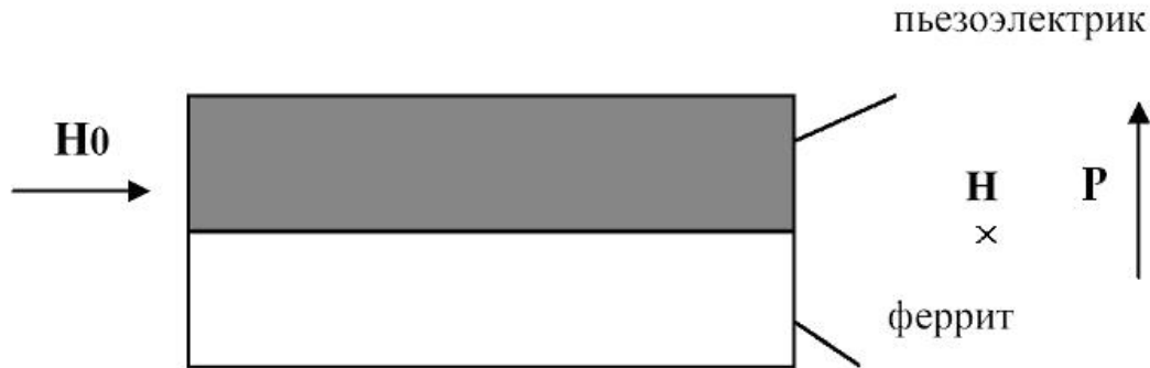
Рисунок 1. Двухслойная феррит-пьезоэлектрическая структура. \mathbf{P} – вектор поляризации пьезоэлектрика, \mathbf{H}_0 – подмагничивающее поле. Переменное поле \mathbf{H} направлено перпендикулярно плоскости рисунка
